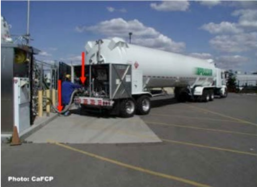
Σχήμα 16: Μεταφορά υγρού υδρογόνου σε μονωμένη δεξαμενή.
