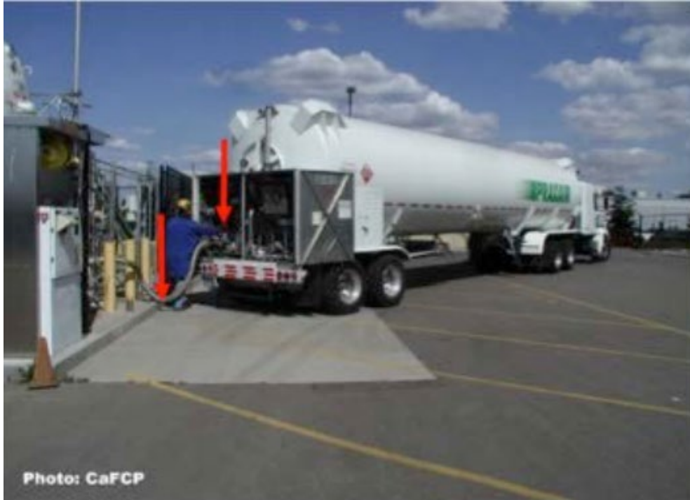
Abbildung 16: Transport von flüssigem Wasserstoff in einem isolierten Tank.
