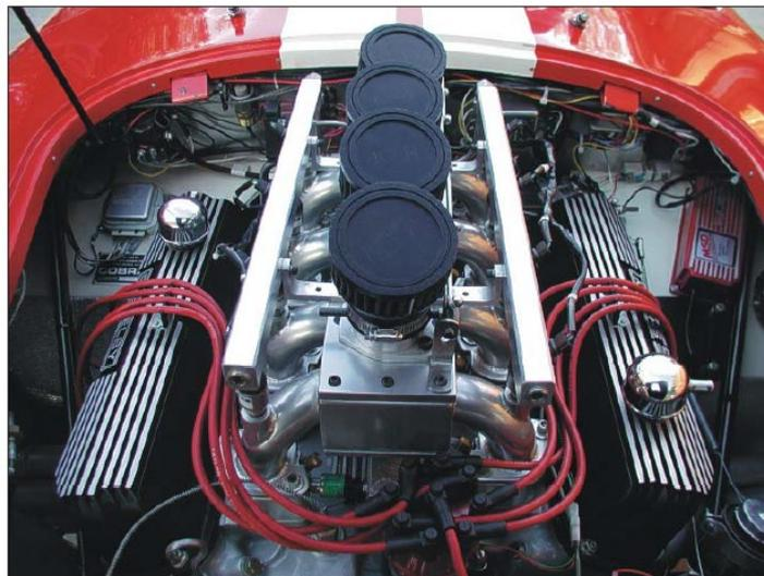
Abbildung 6. Ein Wasserstoff-Verbrennungsmotor.
