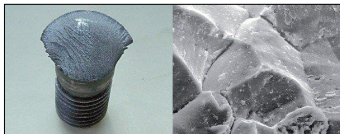
Abbildung 3. Bolzen und Bruchfläche
