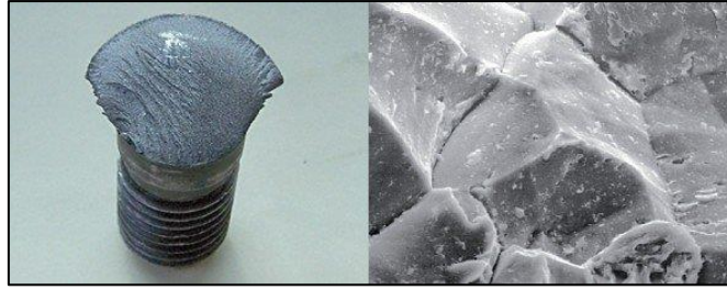
Εικόνα 3. Βίδα και επιφάνεια ρωγμών
