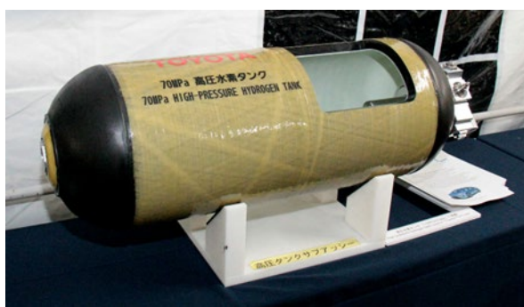
Εικόνα 16. Σύνθετη δεξαμενή αποθήκευσης υδρογόνου.
